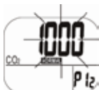
Abb. 9: Einstellung der CO 2 -Obergrenze für den normalen Bereich
