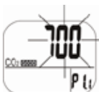
Abb. 8: Einstellung der CO 2 -Obergrenze für den optimalen Bereich
